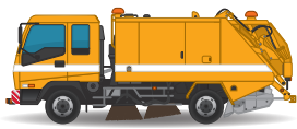
スウィーパーとは ⇒道路の汚れ、ごみを走りながら掃除する路面清掃車のこと
